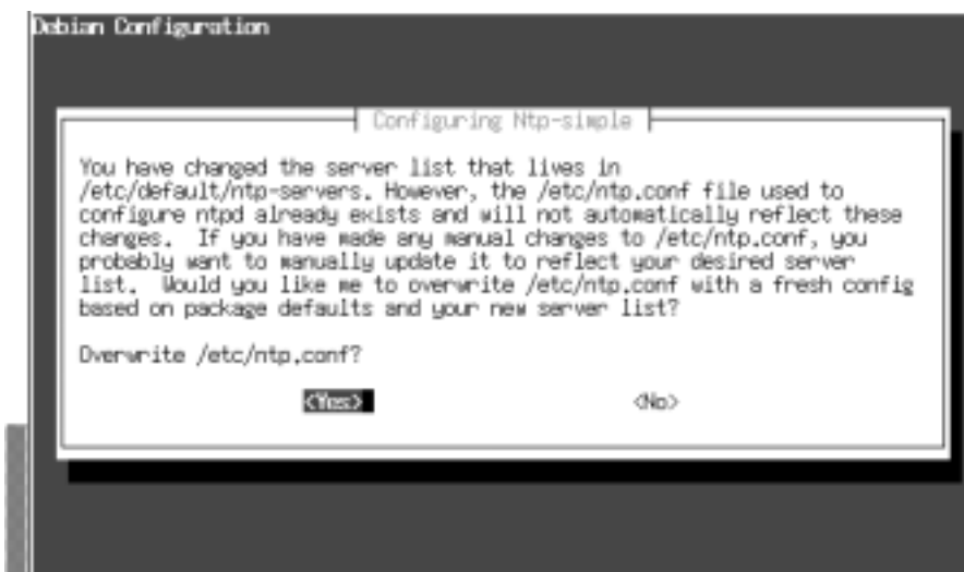
図3 ntp-simpleの設定(2) : はじめてntpを入れたときはYesを、/etc/ntp.confを手で修正している人はNoを選択してください。
